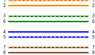
Схема разводки (T568B)
